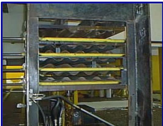
Figura 4. Prensa a frio para formatação das telhas a partir de placas
