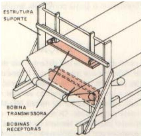
Sistema de Bobinas Sensoras
