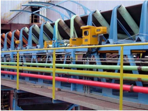
Balança 1014 com pesos estáticos para calibração
