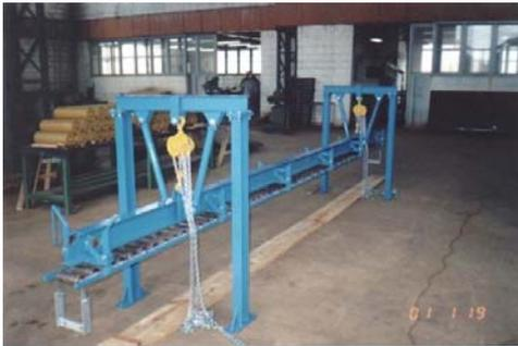
Corrente de Calibração pré-montada em fábrica
