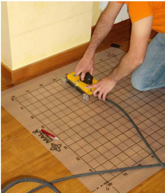
Fig. 9 – Detecção de armaduras e medição da espessura do pavimento através da técnica de georadar.
