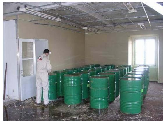
Fig. 13 – Ensaio de carga para verificação da eficácia do reforço.
