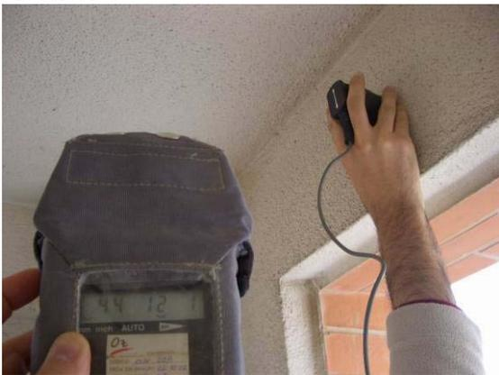
Fig. 7 – Detecção de armaduras com o pacómetro.
