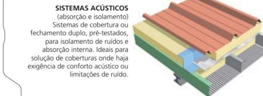
**SISTEMAS ACÚSTICOS** (absorção e isolamento)
