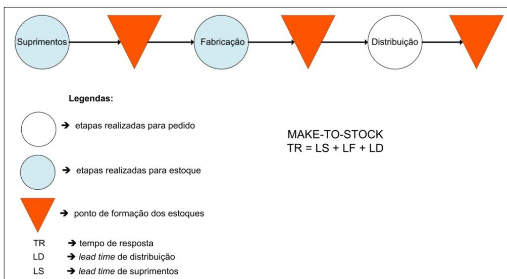
Figura 19: Fluxo do processo *Make-To-Stock* da empresa
